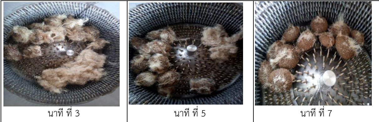
ภาพที่ 11 ประสิทธิภาพของเครื่องดัดเส้นใยตาลทำการดัดเส้นใยตาลจากเมล็ดตาลแห้ง ณ เวลา ที่แตกต่างกัน
