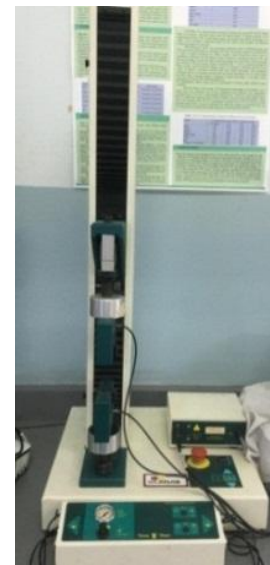
ภาพที่ 6 เครื่องทดสอบความ แข็งแรงของผ้าต่อแรงดึงขาด
