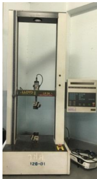
ภาพที่ 5 เครื่องทดสอบความ แข็งแรงของเส้นด้ายต่อแรงดึง ขาด
