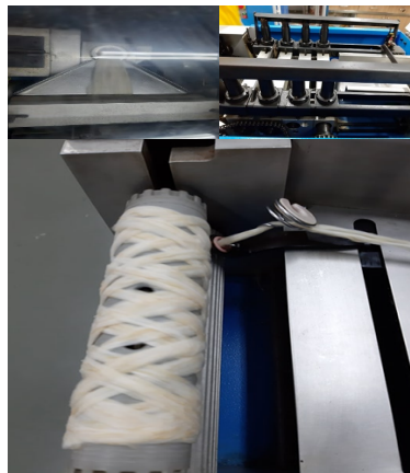
รูปที่ 1 เส้นสไลเวอร์เข้าสู่ขั้นตอนลดขนาดเส้นใยด้วยเครื่องรีดปุย
